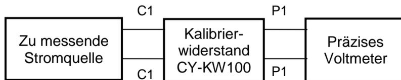
Vor Beginn der Messung, der Netzteil +24VDC muss mit dem Widerstand zur Regelung der Betriebstemperatur des Widerstands im Bereich von 15°C~30°C verbunden werden. Der Widerstand muss 30~45 Minuten vor der Verwendung zur Messung vorgeheizt.
